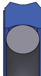
La guarnizione a doppio effetto K70 è composta da un elemento di tenuta in poliuretano blu TPU 95, resistente all'usura, energizzato da un O-Ring in NBR 70. In presenza di pressione da entrambi i lati, due spigoli di tenuta garantiscono una sicura separazione del fluido.
